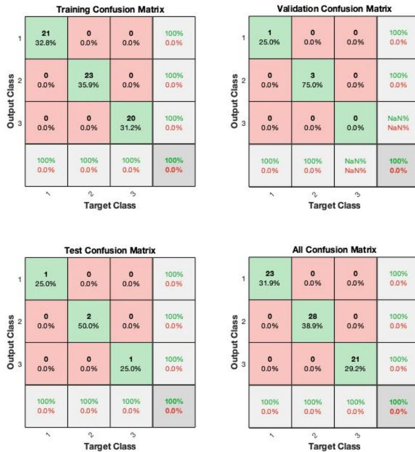
Figura 9: Matrices de confusión del modelo. Durante las etapas de entrenamiento, validación y prueba se muestra que el 100 % de los datos fue clasificado de forma correcta.
