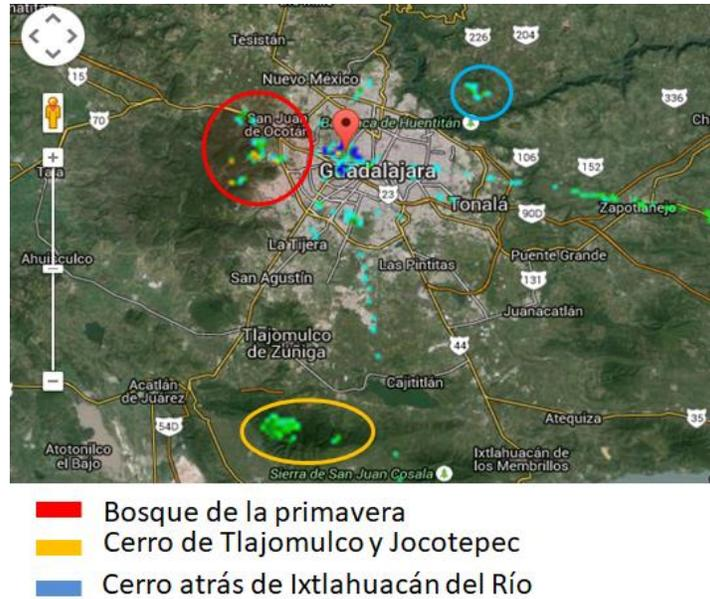
Figura 5. Imagen de reflectividad del radar, los círculos muestran los cerros dentro del AMG que producen ecos fijos (los cerros nos reflejan la radiación recibida de manera constante, reflectividad constante).
