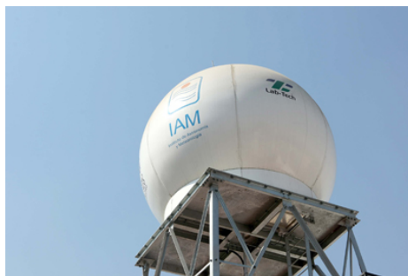
Figura 1: Radar Doppler utilizado en el Instituto de Astronomía y Meteorología
